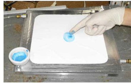
写真 1 25 × 25 cm 平膜モジュールと液体の塗布
